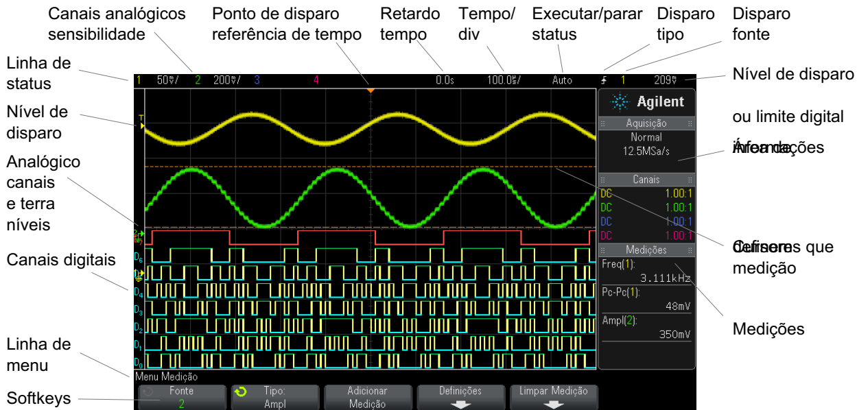
Figura 1 Interpretação da tela do osciloscópio
